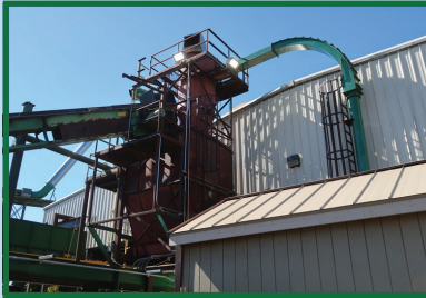
APPROX. 9'W X 9'L X 12'H DUAL SCREW LIVE BOTTOM AUGER
